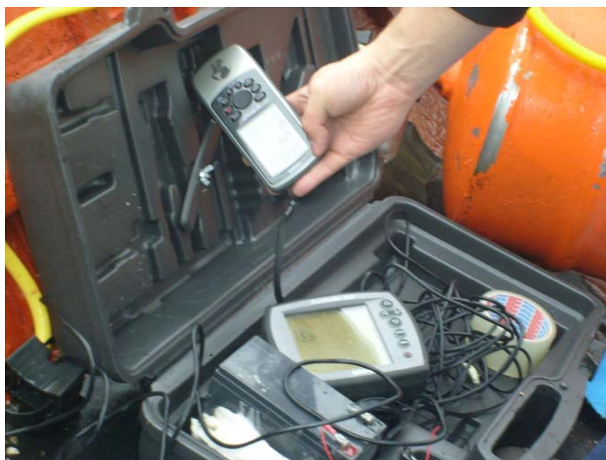
Figura 22. Uso de GPS y ecosonda para verificación de las profundidades.
