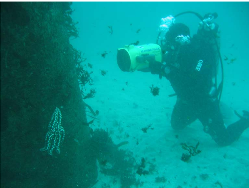
Acercamiento del buzo para toma de imágenes en uno de los pilotes del muelle
