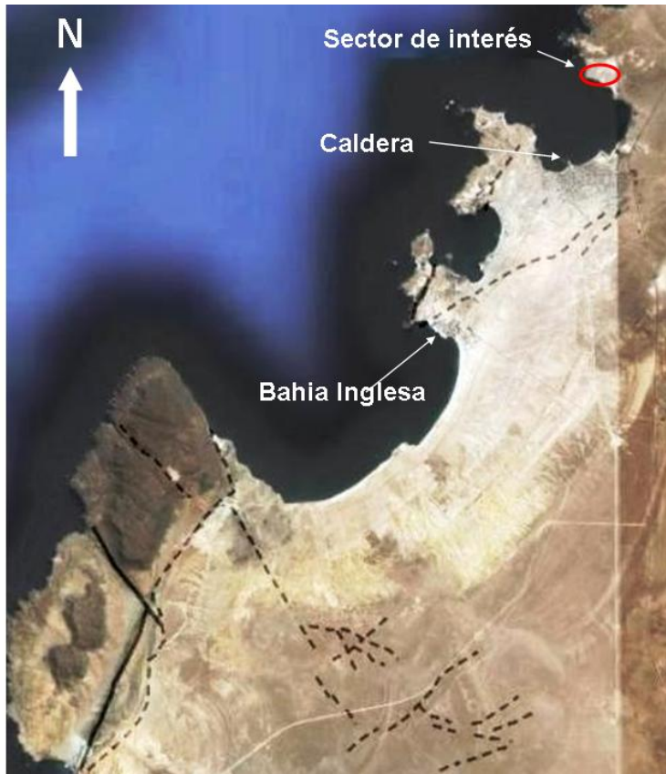
Fotografía 12. Vista aérea del sector Morro Copiapó. Caldera mostrando las fallas observadas en la campaña realizada para este informe. En línea de trazos las falla mapeadas por SERNAGEOMIN en 2003,
