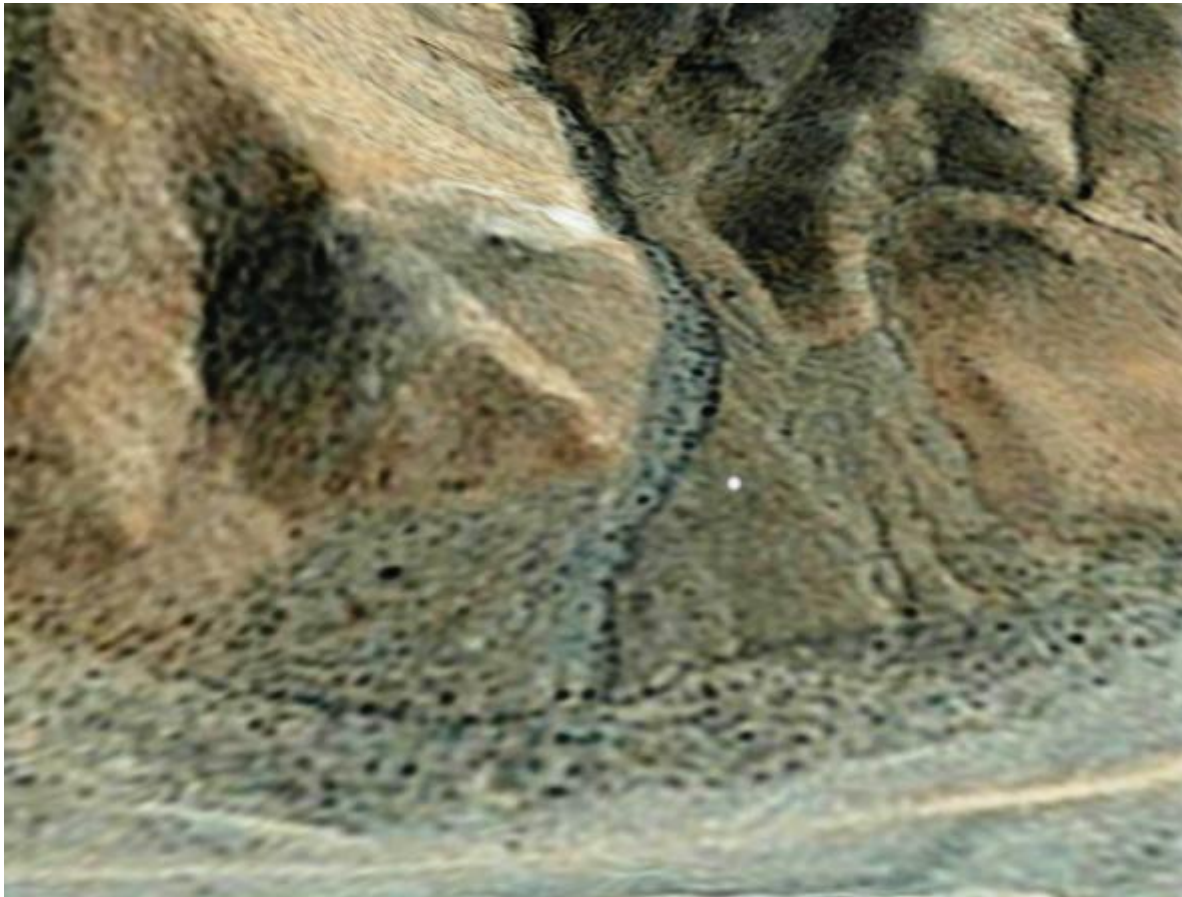
Fotografía 8.10 Vista aérea (Imagen Google) del sector de ubicación de la torre T-226, indicada con el círculo blanco. Se aprecia la cercanía al cauce episódico que disecta el cono.
