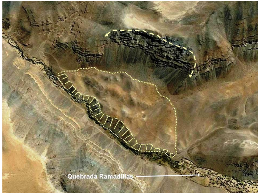
Foto 35. Deslizamiento en masa en la ladera norte de ramadillas. La línea punteada marca el lugar desde donde se desplazó el material. Obsérvese la superficie superior ondulada característica de remoción en masa.
