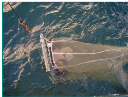
Fotografía 6.5.1. Red para toma de muestras de comunidades fitoplanctónicas.
