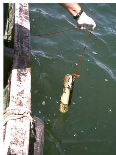
Fotografía 3.3.1.2. Maniobra de introducción del CTD en la columna de agua marina.
