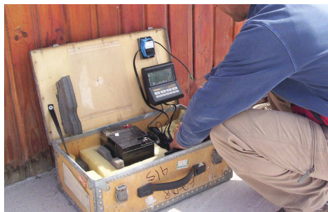
Fotografía 5.5.1.1. Estación meteorológica Weather Wizard III.
